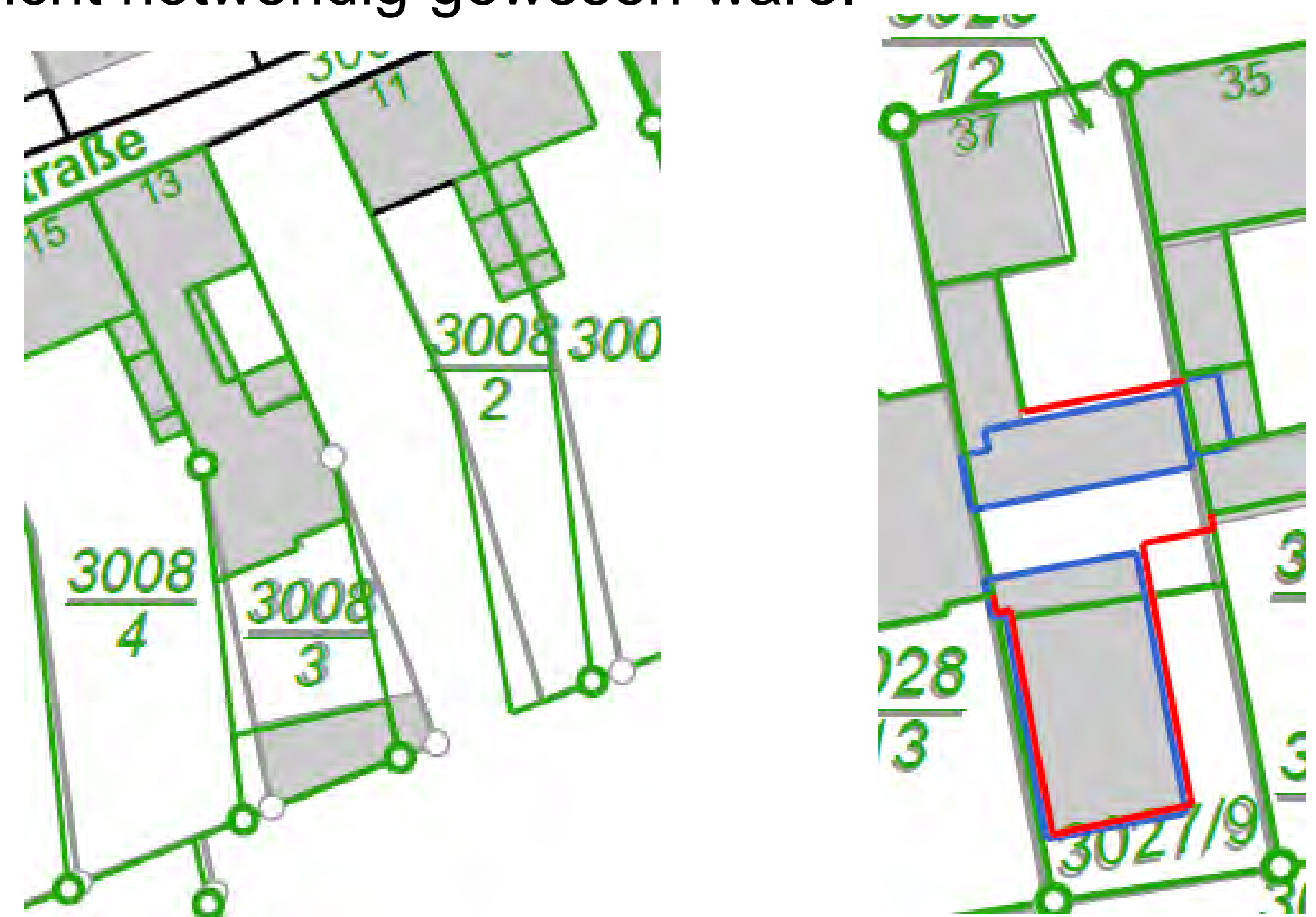
Abb. 2: Veränderung Grundriss im Zuge der SQV (grau: alter Bestand, rot: neu, grün: verändert, blau: gelöscht)
