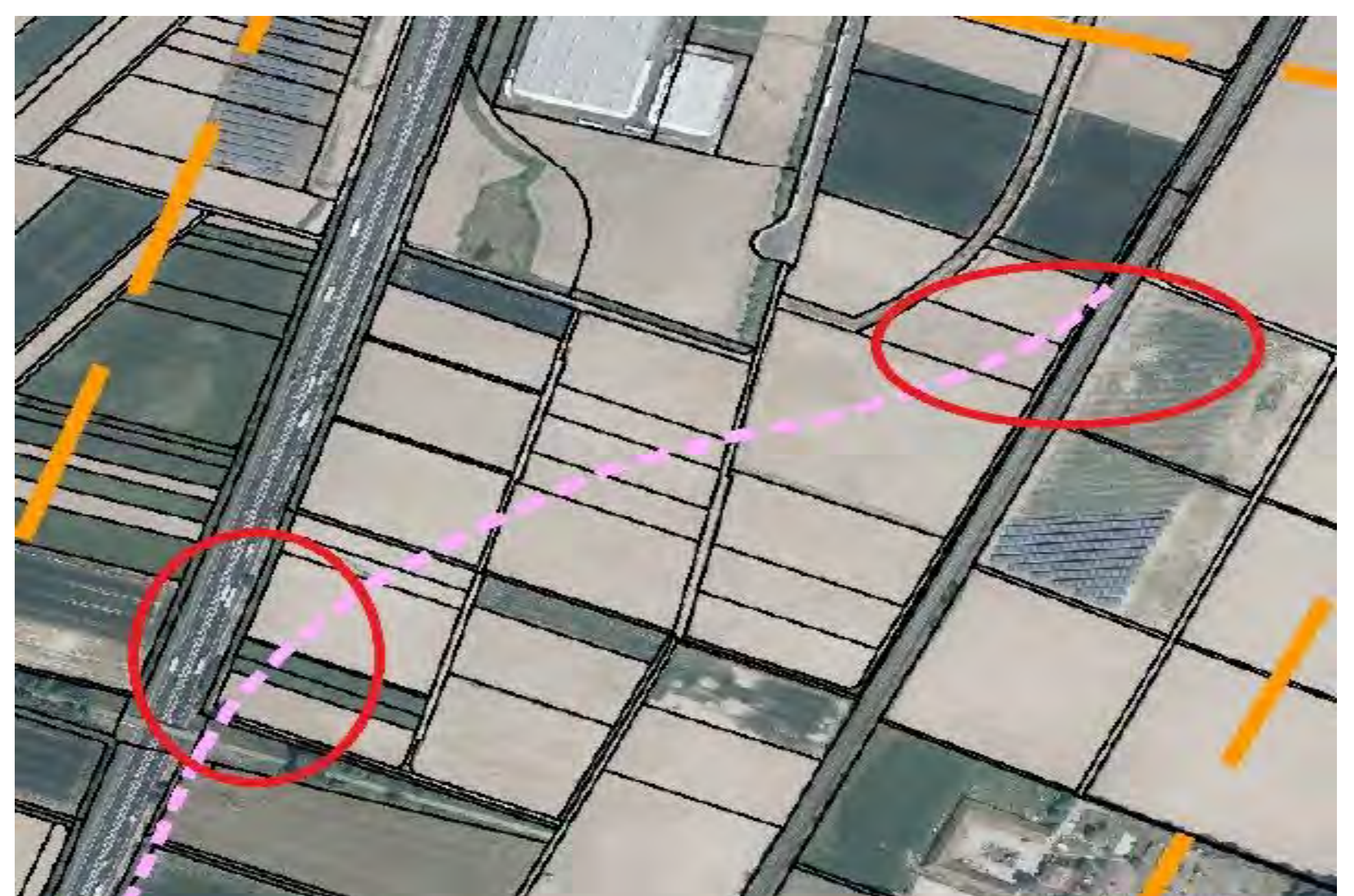
Abbildung 2: Zerschneidungsschäden hervorgerufen durch die Neubautrasse. Markierung: Besonders unförmige Reststücke
