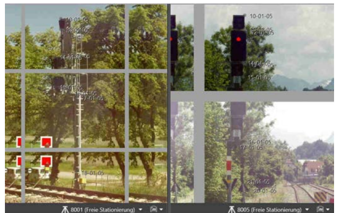
Abb. 2: Auswertung in Leica Infinity mit gemessenen Bildpunkten und der Einzelbilder der Panoramaaufnahme
