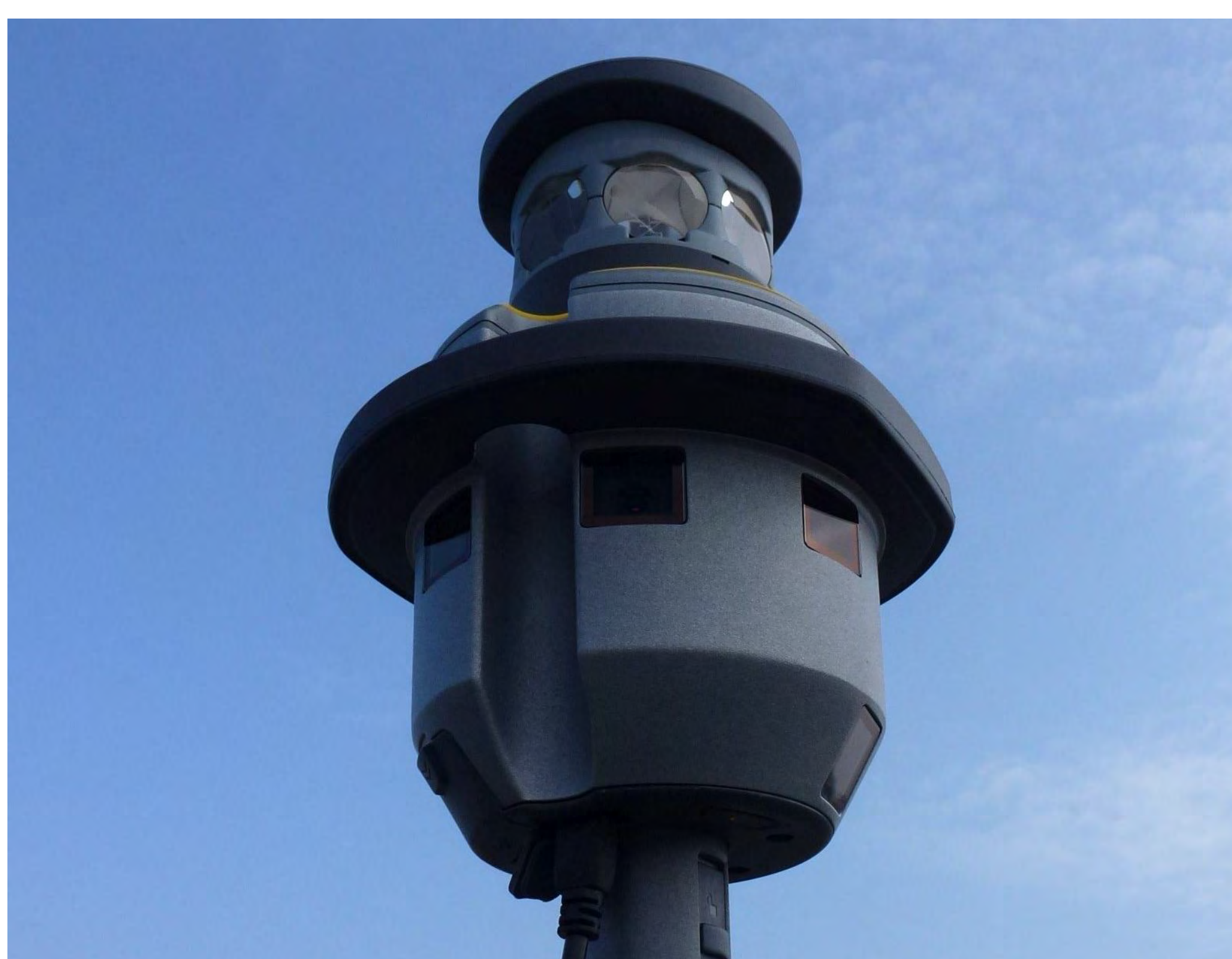
Trimble V10 Kamerakopf mit 360° Prisma
