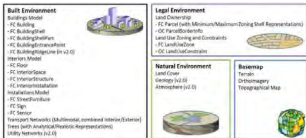
Aufbau der 3DCIM Datenstruktur
