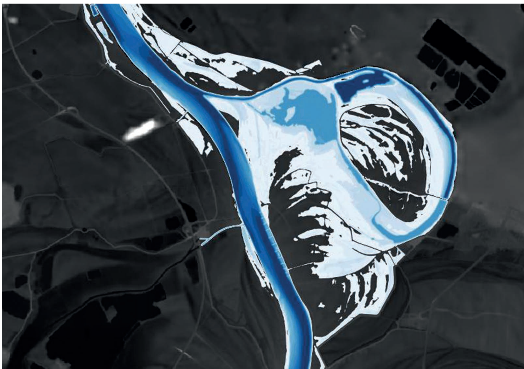
Simulationsergebnisse der Überflutungsflächen aus FLYS bei einem HQ2
