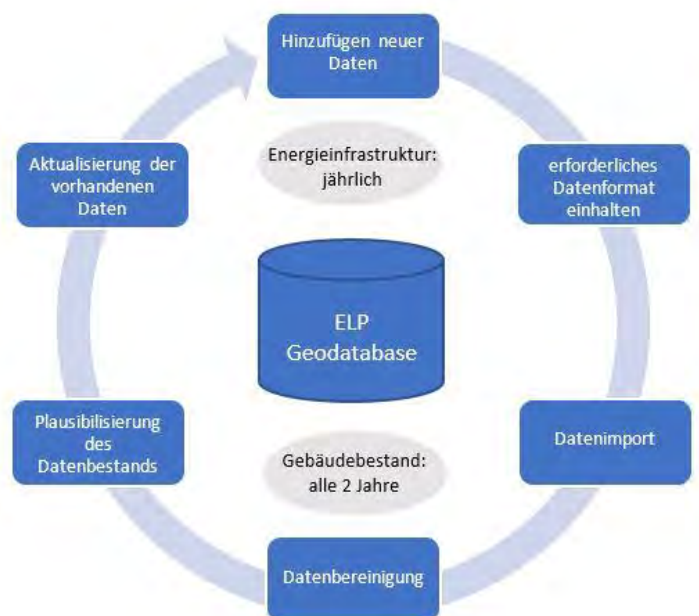
Abbildung 1: Ablauf bei der Aktualisierung des Datenbestands für den Energieleitplan Karlsruhe
