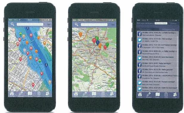
Bereitstellung der Daten in einer Karte in verschiedenen Zoomstufen und einer Liste für Daten aus Social Networks und Microblogs
