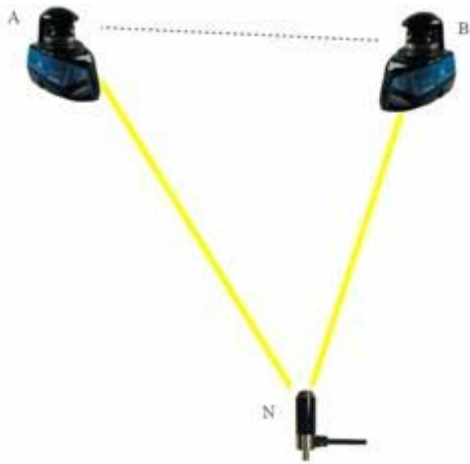
Abb. 2: Messprinzip zur Positionsbestimmung des Empfängers N bei bekannten Positionen der Transmitter
