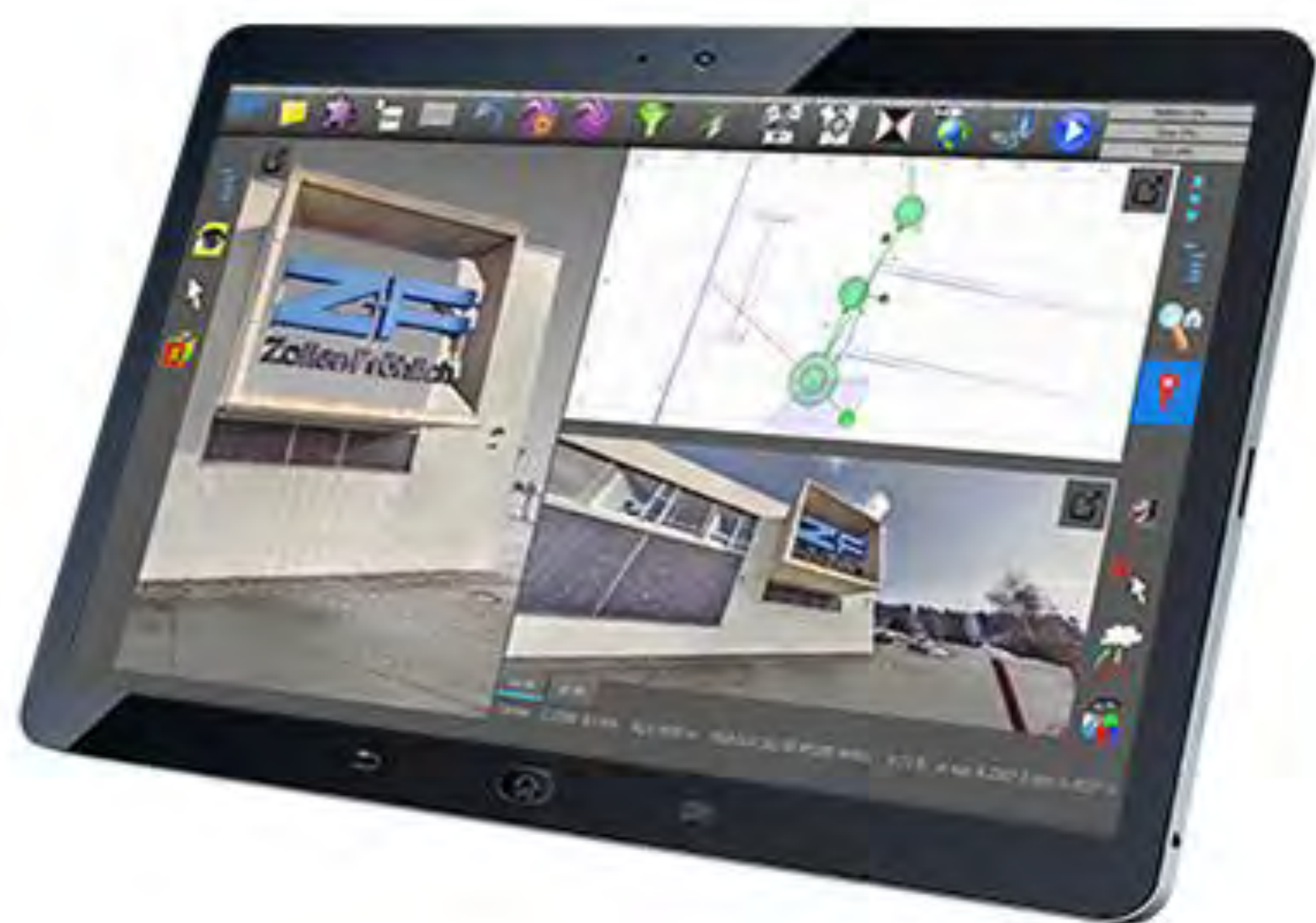
Abb. 1: Tablet mit der Software LaserControl Scout zur Registrierung direkt bei der Aufnahme des Objektes
